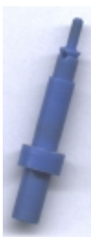
Slika 1: «Samsung test-ključ» za namještanje «kalibracijskog koda»
